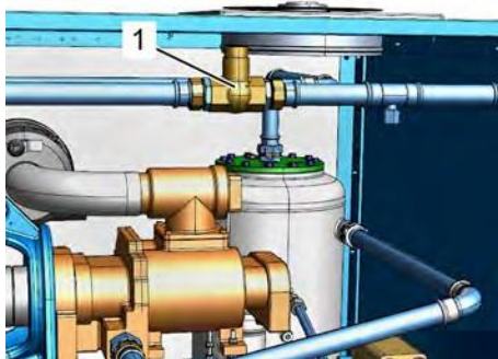
Рис. 18: Клапан минимального давления/обратный клапан
