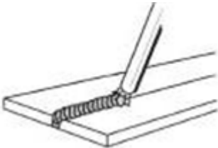
Рисунок 12. Нижнее положение при сварке
