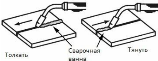
Рисунок 19. Направление движения горелки
