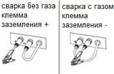
Рисунок 16. Полярность при полуавтоматической сварке
