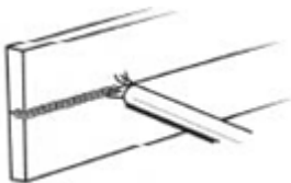
Рисунок 13. Горизонтальное положение при сварке
