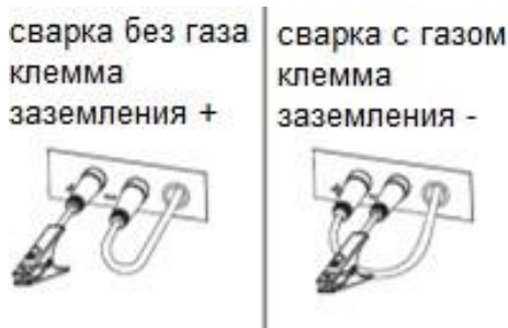
Рисунок 16. Полярность при полуавтоматической сварке
