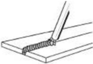
Рисунок 12. Нижнее положение при сварке
