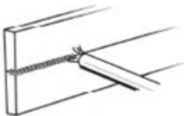
Рисунок 13. Горизонтальное положение при сварке
