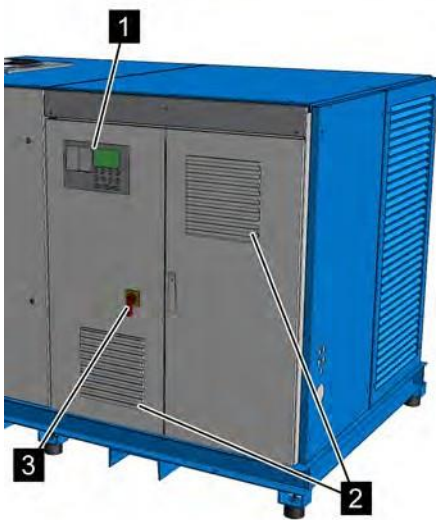
Рис. 11: Элементы управления и фильтр распределительного шкафа
